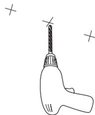
Faça a marcação e fure o teto com broca de alvenaria 6mm
