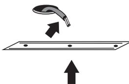
Passe os cabos da rede elétrica e os cabos de dimerização 0-10V no furo central da peça
